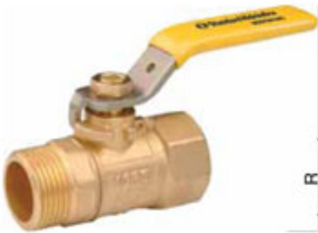
Применение: для транспортировки жидкостей и газов по трубопроводам. Опция: Латунный корпус, шарик и седла из нержавеющей стали, рукоятка из ПВХ Основные параметры: Латунь, Размеры, (мм) Ду 15-32, Раб. = 5 бар
